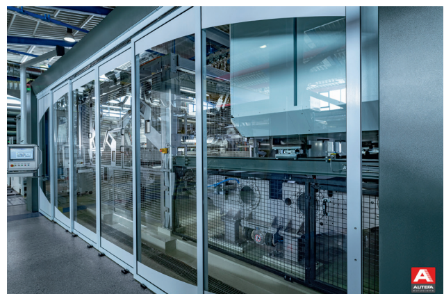
Abb. 4: Spunlacemaschine V-Jet FUTURA.
