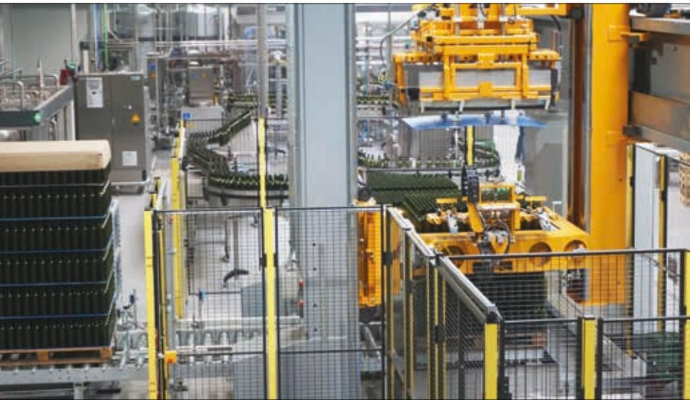
*Der Entpalettierer von Autefa ist in der Lage die Trays der unterschiedlichen Flaschentypen vollautomatisch aufzureißen.*
