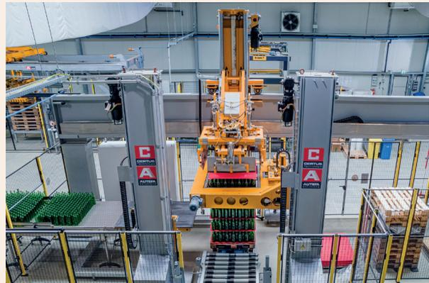
ternehmen von Bedeutung. Der Neuglasabschieber Certant R wurde um das Anti-Flaschenbruch-Modul erweitert. Das patentierte Anti-Flaschenbruch-Modul reduziert signifikant Glasbruch. Die Flaschen werden hierzu bei jeder Hub- und Schiebewegung gesichert und bleiben während des Abschiebens so lange fixiert, bis der Abschiebekopf über dem Flaschenhals steht. Das Risiko, dass Flaschen vor oder während des Abschiebevorgangs herabfallen, wird somit nachweisbar reduziert.
